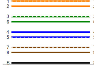
Schéma de câblage (T568B) CORRECT
